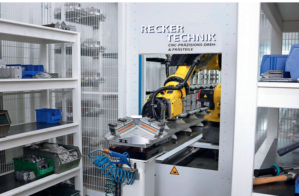
1 Der Roboter übergibt eine Spannpyramide mit drei Schraubstöcken in die Bestückungsschleuse der Fertigungszelle © InterCAM
