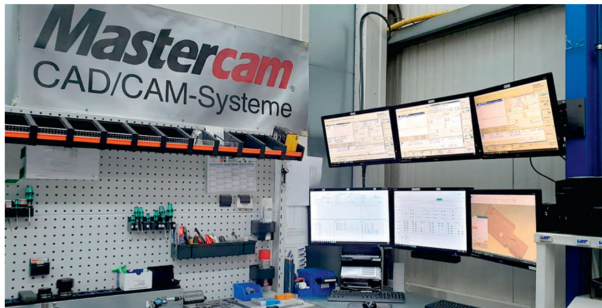
2 Der zentrale Kommandostand der Fertigungszelle mit Anbindung zum Datenmanagement MDM © InterCAM
